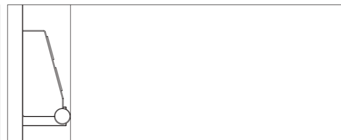
Vertikalschnitt Seitenwand, Bedientableau EN 81-70-B.
