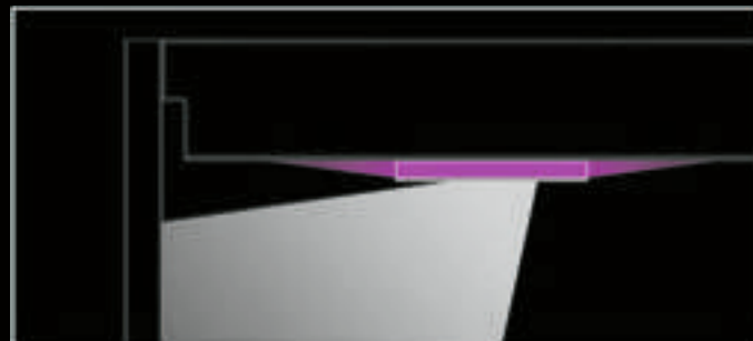
Vertikalschnitt LD7-LED-RGB-Wandfluter. Funktionsschema Direkt- und Indirektbeleuchtung.
