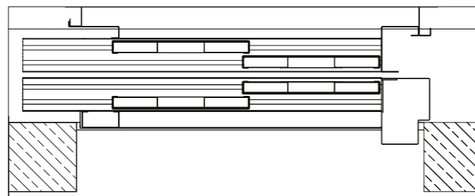
Horizontalschnitt Tür einseitig öffnend / Servicezarge.
